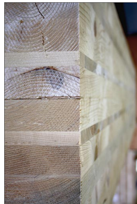
Abb. 3: Brettspertholz ist belastbarer und formstabiler als gewachsenes Holz
