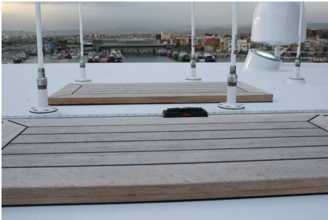
Probeflächen aus Esche auf einer Yacht montiert (Bewitterung im Praxistest)
